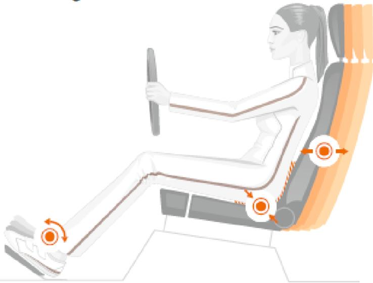
2. Die Schultern so dicht wie möglich an die Sitzlehne rücken. Die Rückenlehnenneigung so ausrichten, dass das Lenkrad mit leicht angewinkelten Armen gut erreicht wird. Beim Drehen des Lenkrads muss der Schulterkontakt erhalten bleiben.
