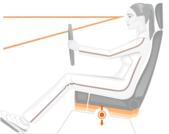
4. Die Sitzflächenneigung so ausrichten, dass die Pedale leicht durchgetreten werden können. Die Oberschenkel sollen leicht aufliegen, ohne Druck auf das Sitzkissen. Überprüfen Sie vor dem Start die Rückenlehnenneigung.
